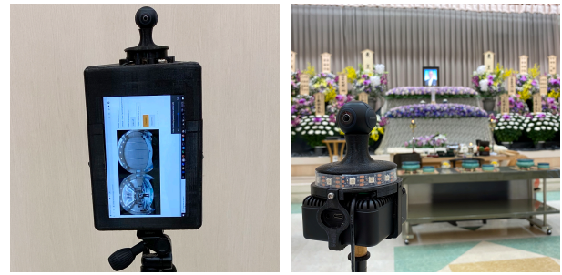
図 3: Node モジュール (左: Surface Go 一体型 < Node1, 2 >, 右: Jetson Nano に接続して使用 < Node3 >)
